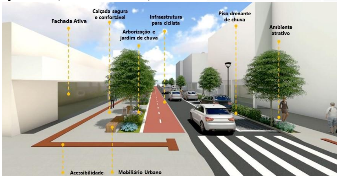
Figura 95 – Componentes de uma rua completa
