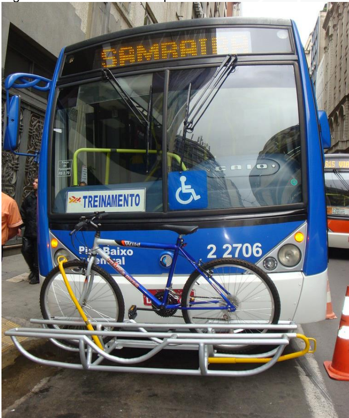
Figura 73 – Modelo de rack para bicicleta instalado em veículo de transporte coletivo em São Paulo
