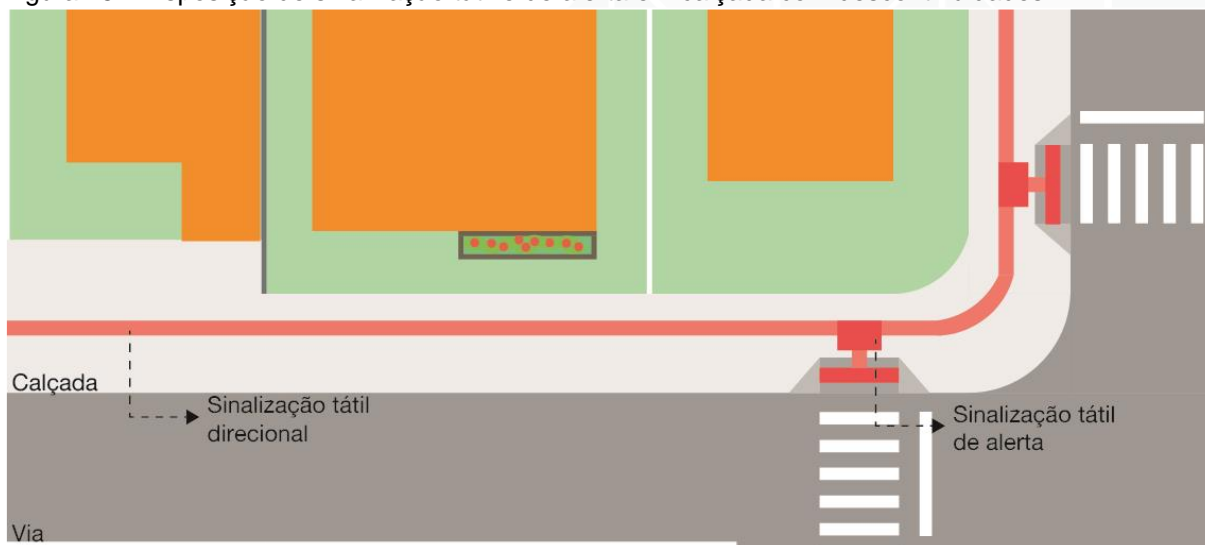
Figura 15 - Disposição de sinalização tátil e de alerta em calçada com discontinuidades
